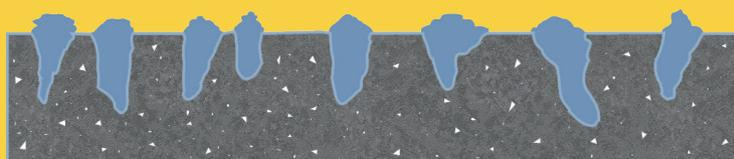
**Superficie tratada húmeda:** el antiSLIP system® reacciona directamente con cualquier forma de humedad y crea un efecto de frenado basado en un alto coeficiente de fricción. Gracias a ello se puede prevenir el llamado efecto aquaplaning.
